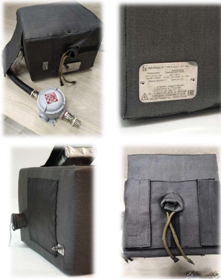
Пример защитного модуля для датчика КИПиА
